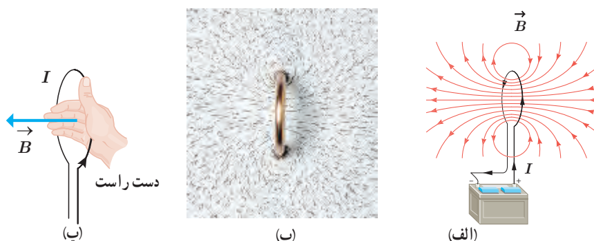
شکل ۳-۱۷ الف) خط‌های میدان مغناطیسی در اطراف یک حلقه حامل جریان. ب) طرح خط‌های میدان مغناطیسی یک حلقه حامل جریان با استفاده از برآه‌ده آهن. ب) استفاده از قاعده دست راست برای تعیین جهت \vec{B} یک حلقه حامل جریان.
