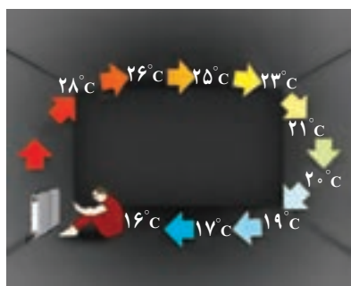
شکل ۴-۲۸ گرم شدن هوای اتاق به روش همرفت
